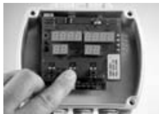
Sur le modèle 600, on peut accéder au clavier par ouverture du boîtier.
