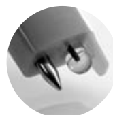
Electrode pH1 pour milieu liquide avec capot de protection
