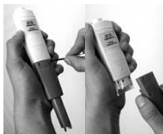
Echange simplifié de l'électrode sur les testo 205, testo 206-ph1/-ph2/-ph3
