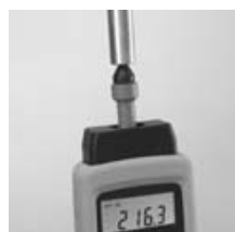
Mesure mécanique avec pointe de contact
