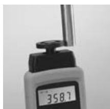
Mesure mécanique avec roulette
