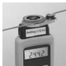
Mesure mécanique pour mesure de défilement
