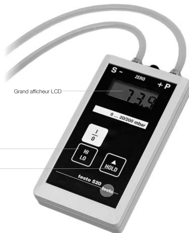
Deux échelles de mesure commutables par simple impulsion
