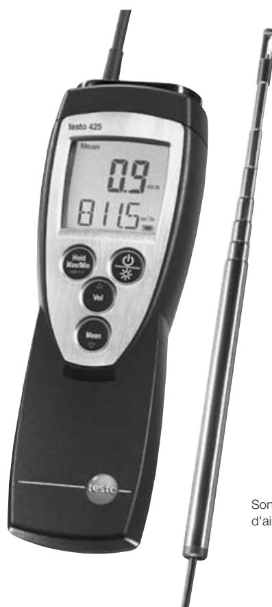
Sonde télescopique de vitesse d'air (max.820 mm)
