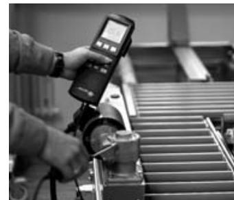
Grâce aux appareils de mesure portables testo, il est possible de réaliser des contrôles ponctuels lors de la production ou à la livraison. Les données de mesure peuvent être immédiatement transmises dans un bureau central grâce à l'adaptateur Ethernet. Ceci permet de réagir rapidement lorsqu'il est nécessaire d'intervenir par ailleurs.
